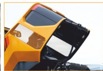
Опрокидывающийся капот двигателя для удобного обслуживания
